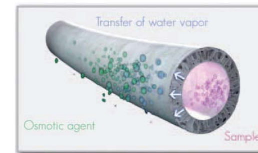
Schéma en coupe du transfert d'eau au sein d'une fibre creuse Crédit : Ederna.
